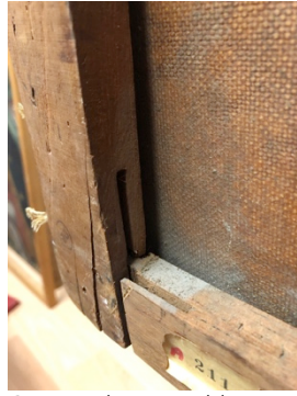
Cassure des assemblages, clés manquantes
