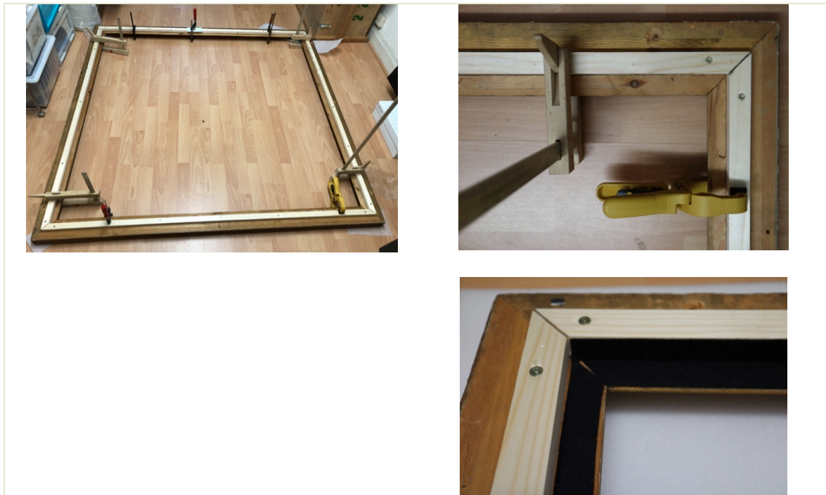
Agrandissement de la batée par collage et vissage de lattes en bois
